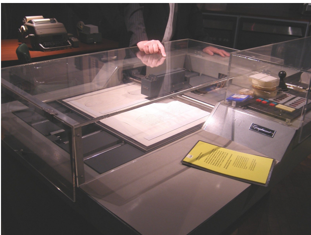
Zuse Z64 Graphomat, début des années 1960. Les traceurs transforment les coordonnées calculées en traits matériels : le code rencontre enfin le papier. Photo : Steve Parker, CC BY 2.0 — Wikimedia Commons.
